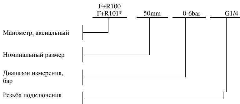
\* Манометры F+R101 оснащены зеленым сектором и красным указателем для фиксации показаний прибора.
